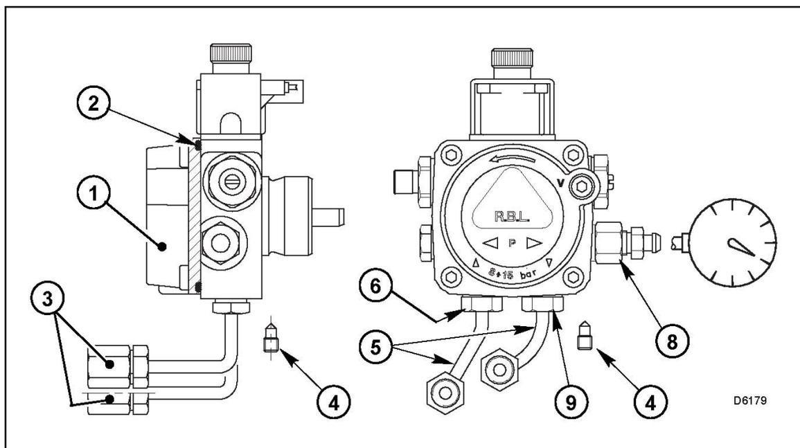
F-10 OIL FIRED BURNER - PARTS DIAGRAM
