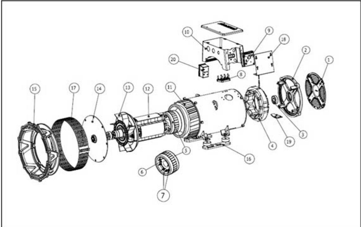
FIGURE 27. S0/S1 SINGLE BEARING ALTERNATOR
