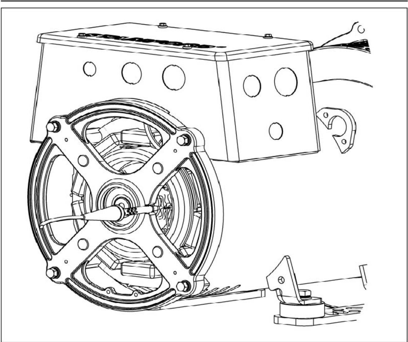
**FIGURE 25. REMOVAL OF DIODE SOLDER**
