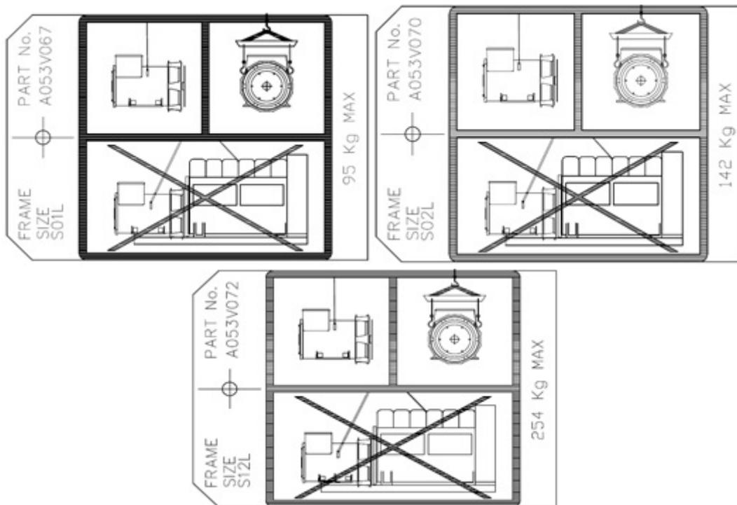
FIGURE 18. LIFTING LABELS
